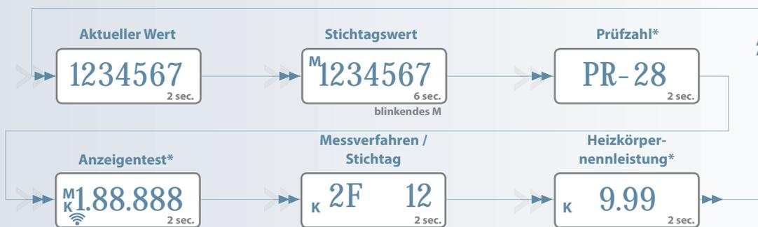
\* Diese Anzeigen können je nach Konfiguration des Heizkostenverteilers abgeschaltet sein.
